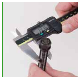
① Messen Sie den Spindeldurchmesser. Measure the spindle diameter.
