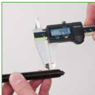
③ Messen Sie die Länge über 3 Gewindegänge. Measure the length over three turns of the thread.
